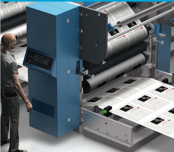
In Druckmaschinen werden unsere USGT eingesetzt, um das Papier für den bevorstehenden Druck genau auszurichten. Hier brilliert die USGT durch ihre hohe Linearität und Wiederholgenauigkeit.
