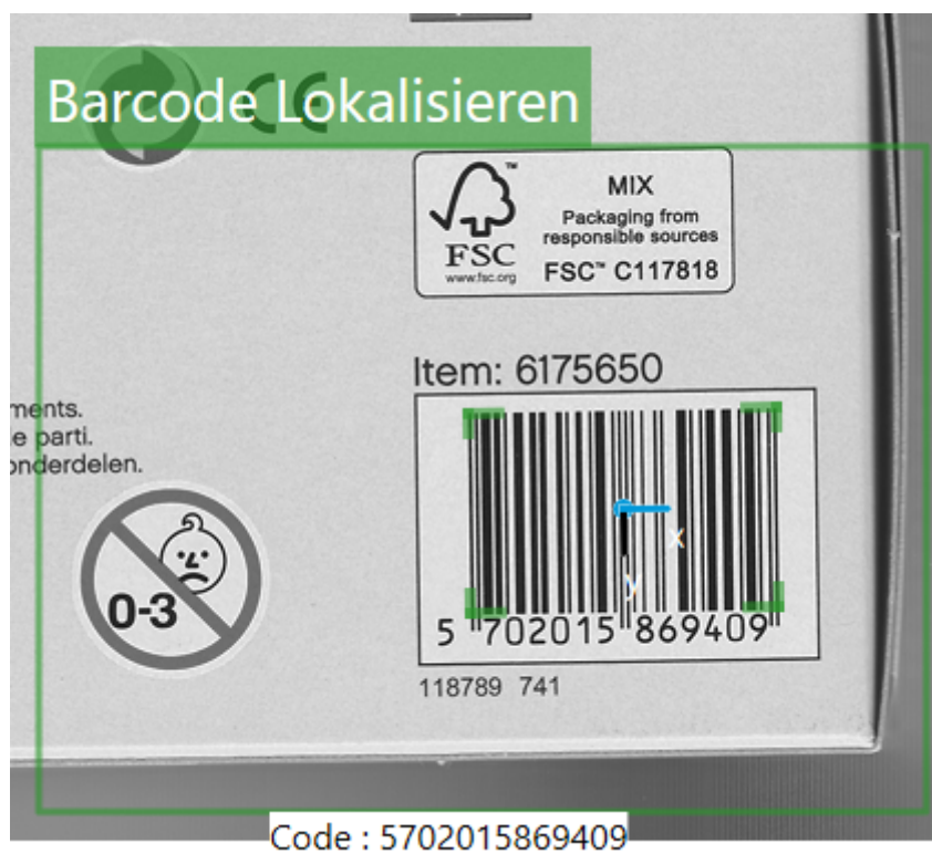
Abb. 65: Das Bild-GUI des Werkzeugs Barcode Lokalisieren .
