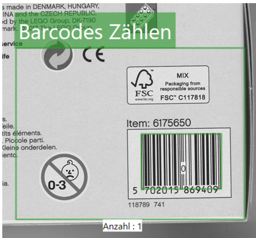
Abb. 56: Das Bild-GUI des Werkzeugs Barcodes Zählen .
