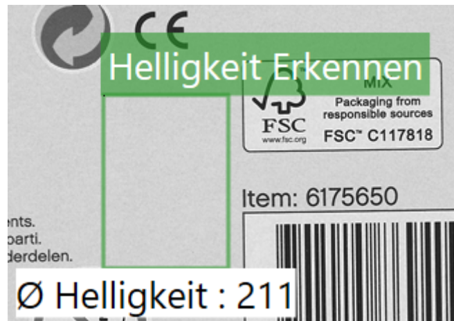
Abb. 79: Das Bild-GUI des Werkzeugs Helligkeit Erkennen .
