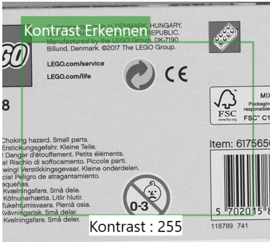
Abb. 85: Das Bild-GUI des Werkzeugs Kontrast Erkennen .
