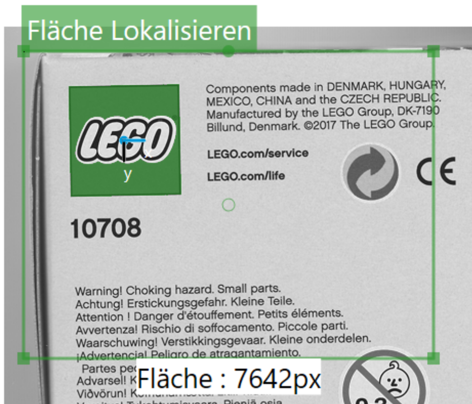
Abb. 62: Das Bild-GUI des Werkzeugs Fläche Lokalisieren .
