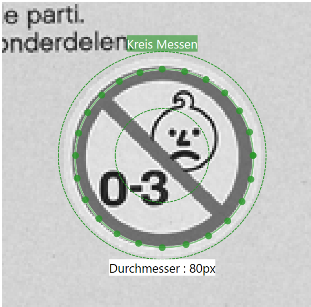
Abb. 82: Das Bild-GUI des Werkzeugs Kreis Messen .
