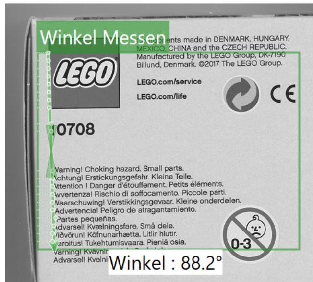
Abb. 75: Das Bild-GUI des Werkzeugs Winkel Messen .
