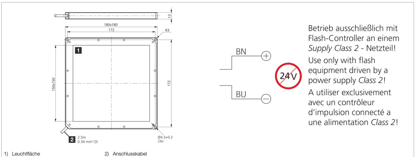
Betrieb ausschließlich mit Flash-Controller an einem *Supply Class 2* - Netzteil!
