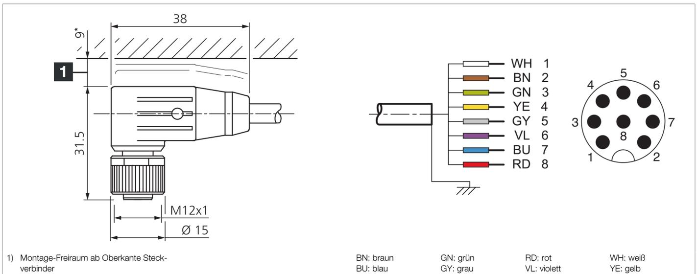
1) Montage-Freiraum ab Oberkante Steckverbinder
