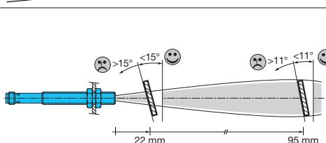
Die Wandleroberfläche sowie der Bereich der Detektionskeule ist zwingend frei zu halten. Es ist darauf zu achten, dass keinerlei störende Objekte zwischen dem Sensor und dem Zielobjekt innerhalb der Keule sind.
