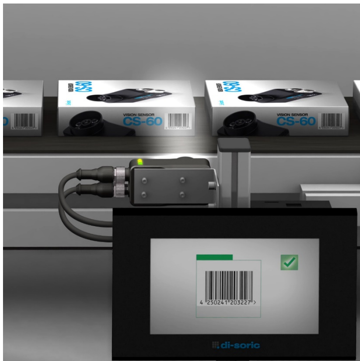
Bild 2: ID-Reader ID-600 von di-soric: Qualitätsprüfung und Erfassung von Barcodes im Rahmen der Sekundärverpackung.
