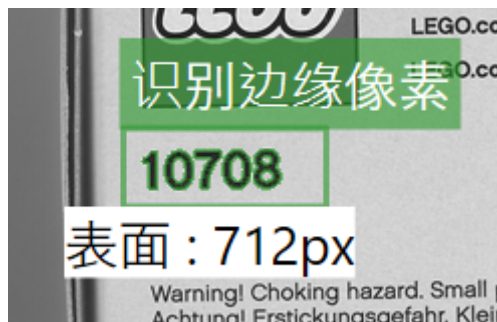
图 66: 识别边缘像素工具的图像 GUI。
