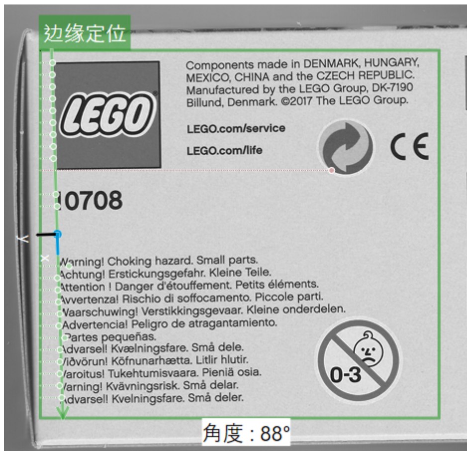
图 88: 边缘定位工具的图像 GUI。
