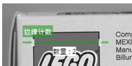
图 69: 边缘计数 工具的图像 GUI。
