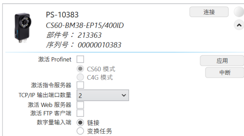
图 36: CS-60/ID-600，数字量输入端的默认设置。
