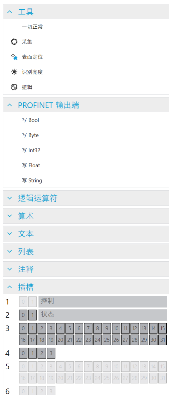
图 128: PROFINET 输出端区域中的快捷菜单。
