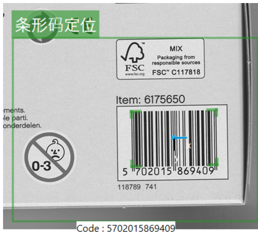
图 85: 条形码定位工具的图像 GUI。
