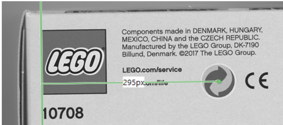
图 112: 测量点到线距离工具的图像 GUI。
